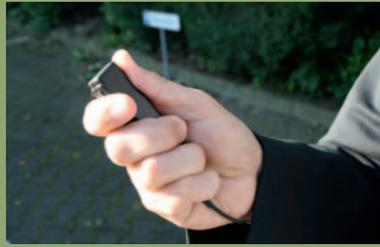
Für die halbverdeckte Ermittlung bietet OnGuard I-Flex eine Kommunikationslösung in transparenter Optik. Die kleine Sendetaste mit einem integrierten Mikrofon kann in der Hand verborgen werden.
